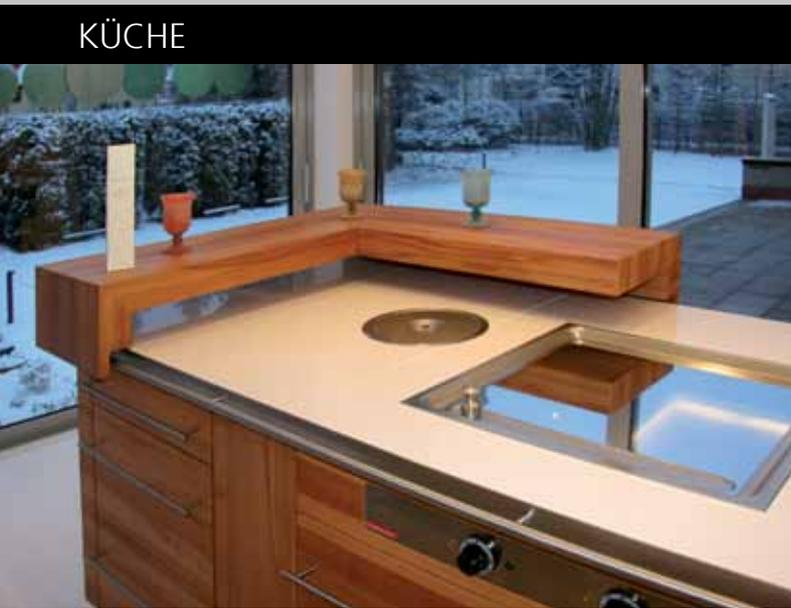
Die Arbeitsplatte ist gefliest, mit Edelstahlkante und einer Reeling. Die Konsolen mit Schneitbrettern vorn und eine Bar am hinteren Ende der Kücheninsel lassen sich auf der Rehling nach Belieben verschieben.
